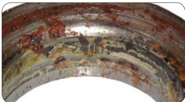
Voorbeeldfoto's van een lager van het HBU1-type waarin water is binnengedrongen (standaardafbeeldingen – niet van VKBA 3496)
