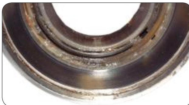
Voorbeeldfoto's van een lager van het HBU1-type waarin water is binnengedrongen (standaardafbeeldingen – niet van VKBA 3496)
